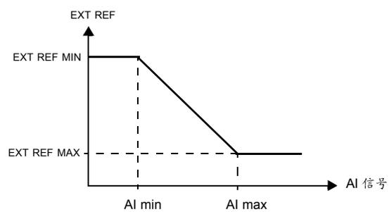
图 38 设定外部给定的低限和高限。依选择的 AI 通道而有所不同，AI 信号的范围由参数 1301 和 1302 或 1304 和 1305 确定。
