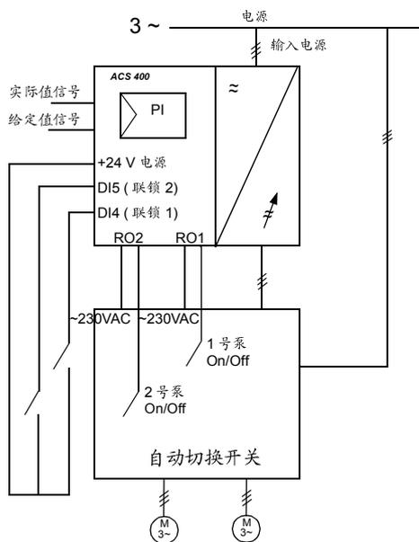
图 75 PFC 宏示意图。使用自动切换功能
