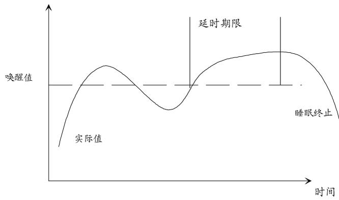
图 60 控制器取反时的睡眠功能。
