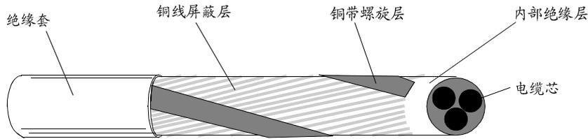
图 77 机电电缆屏蔽的最低要求（例如 MCMK, NK 电缆）
