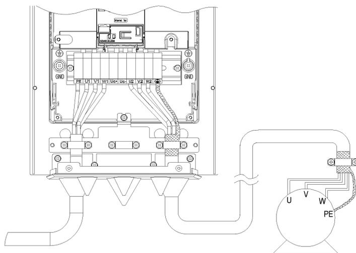
图 26 电机电缆连接, R3 和 R4(IP 54 / NEMA12)
