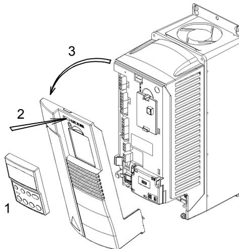
图 8 打开 R1 和 R2 的 IP21/NEMA1 型变频器
