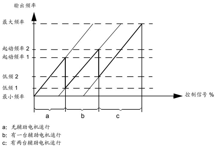
图 65 在一个三电机系统中，控制信号和调速电机频率间的关系
