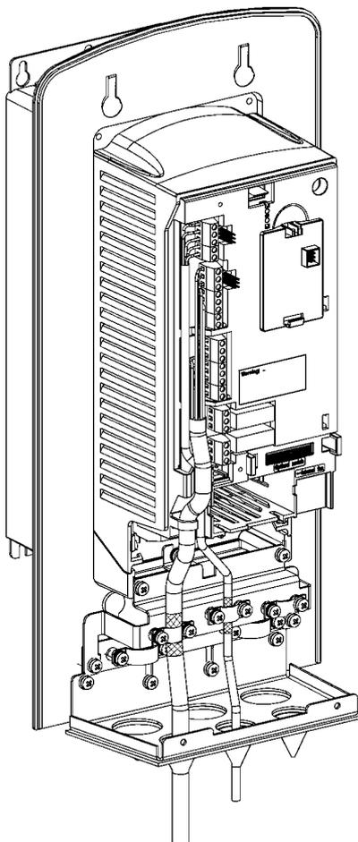
图 28 控制电缆连接 (IP 54 / NEMA12)
