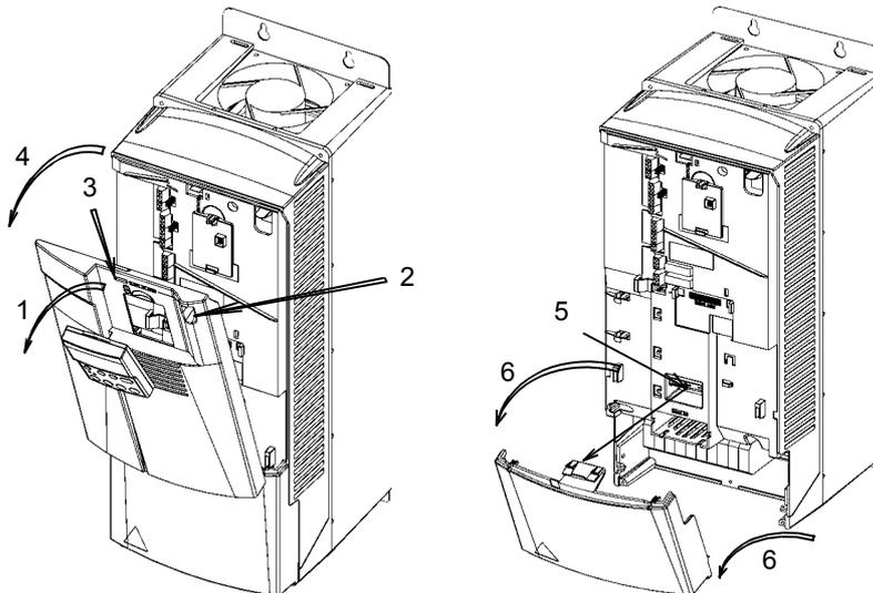
图 9 打开 R3 和 R4 的 IP21/NEMA1 型变频器
