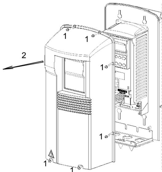
图 10 打开 IP54/NEMA12 型的变频器
