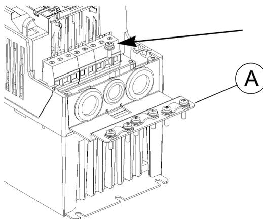
图 18 安装功率电缆板 (A)，IP 21 / NEMA1 变频器
