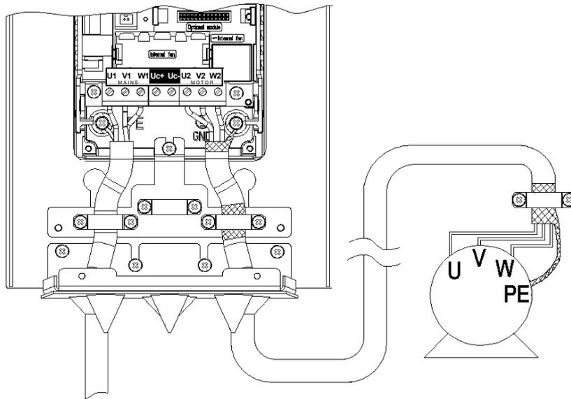
图 25 电机电缆连接, R1 和 R2 (IP 54 / NEMA12)
