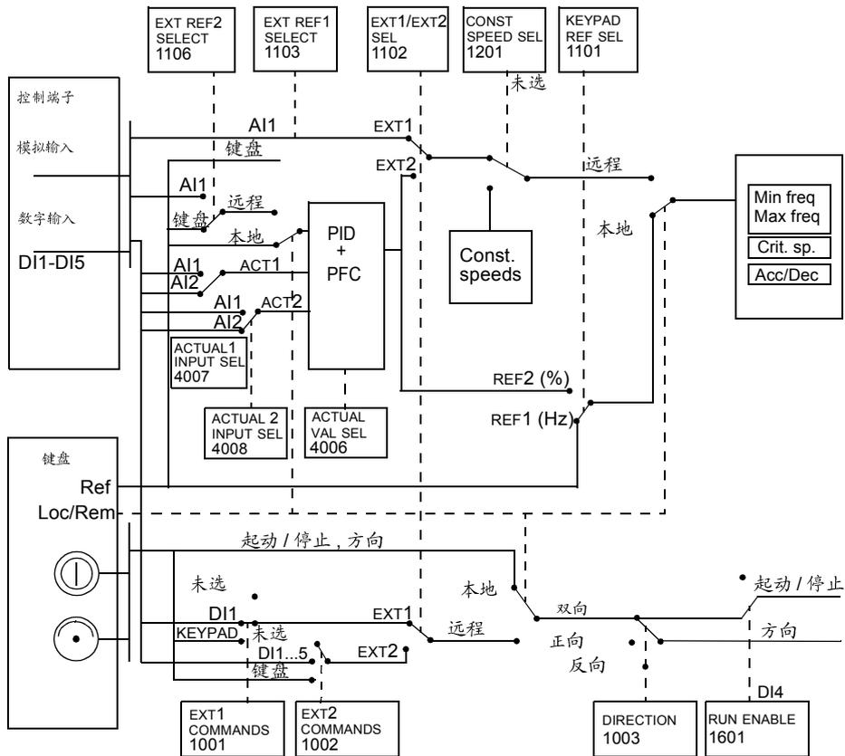
图 76 PFC 宏的控制连接
