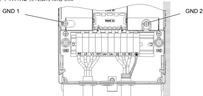
图 16 拆下 R3/R4 模块上的接地螺丝
