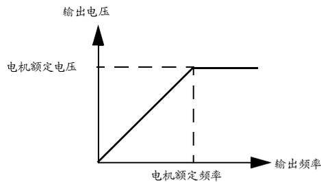
图 36 输出电压与输出频率的关系
