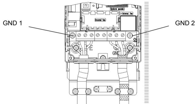
图 15 拆下 R1/R2 模块上的接地螺丝
