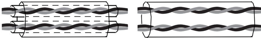
图 80 左边是带屏蔽的双绞线，右边是带屏蔽的多绞电缆。
