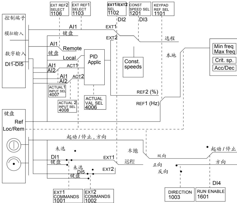
图 73 PID 应用宏的控制连接
