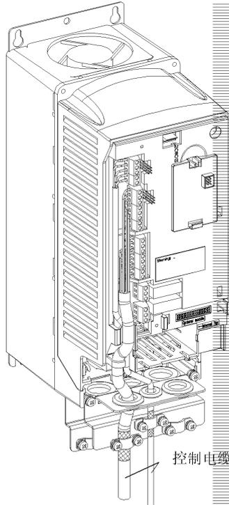
图 22 控制电缆连接 (IP 21 / NEMA1)
