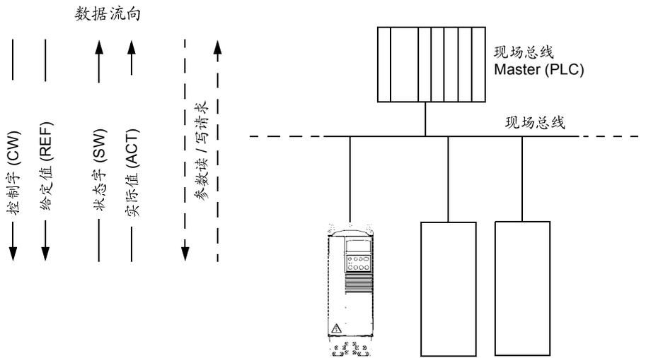
图 67 现场总线结构
