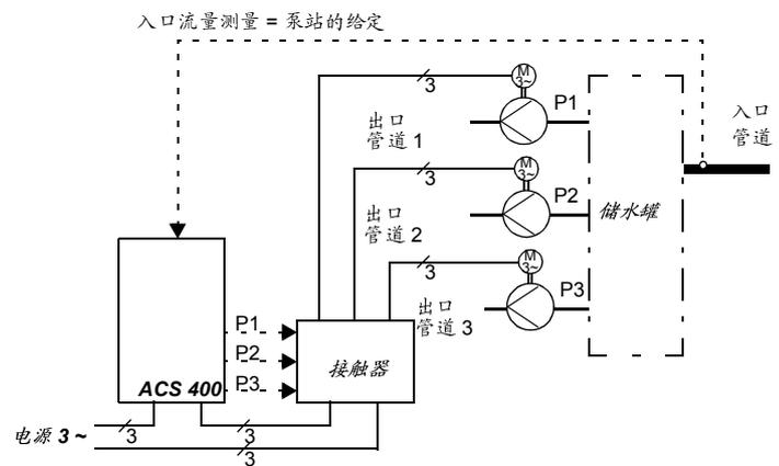
图 64 调节器旁路控制。泵站的出水能力 (出口流量) 随着入口流量值变化
