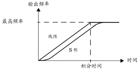
图 42 定义加减速积分时间曲线
